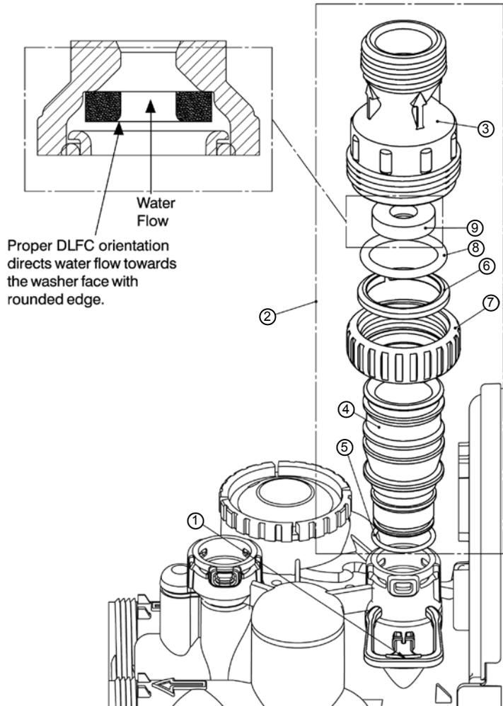
**Water Meter and Meter Plug**
