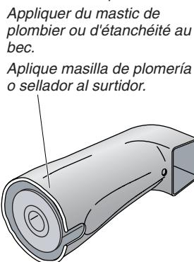
Appliquer du mastic de plombier ou d'étanchéité au bec.
