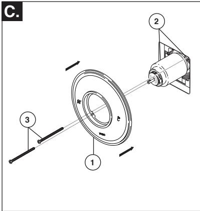
Fixez la rosace (1) sur le support (2) à l'aide des 2 vis fournies (3). Prenez garde de serrer les vis de la rosace excessivement.
