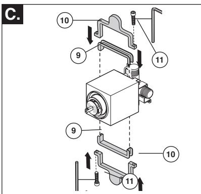
Assemblez les deux manchons de montage (9) et les deux plaques de montage (10). Glissez les plaques de montage sur le manchon de finition de sorte que les plaques et leurs pattes (10) se trouvent au haut et au bas du manchon de finition comme le montre la figure. Vissez les vis (11) dans les plaques de montage juste assez pour maintenir les deux côtés ensemble. Glissez les deux plaques de montage contre le mur et finissez de serrer les vis (11).
