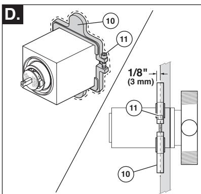
En vous servant des plaques de montage (10) pour vous guider, agrandissez le trou autour du corps de robinetterie pour pouvoir enfoncez les plaques d'au plus  $1/8$  po dans le mur. Serrez les vis (11).
