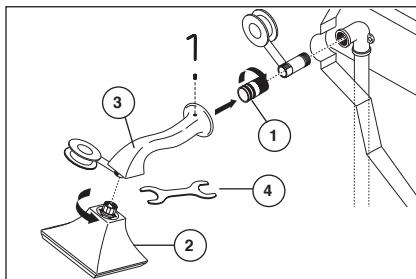
**PARA LA INSTALACIÓN DE LA CABEZA ROCIADORA DE LA REGADERA RSVP® (RP48040), SOTRIA® (RP75722), VIRAGE® (RP62603) Y DEL BRAZO DE LA REGADERA:**
