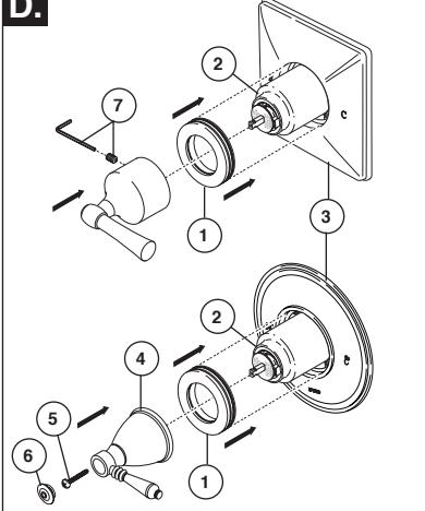
Deslice la argolla de acceso (1) sobre la manga (2) e introduzcalo en la chapa de cubierta (3). **Los modelos T60P210 y T60P410** – Fije la manija (4) en la espiga usando el tornillo (5) y el destornillador de cabeza Phillips. Inserte el botón (6) en la manija. **Otros modelos** – Fije la manija en la espiga usando el tornillo de ajuste y la llave Allen (7).
