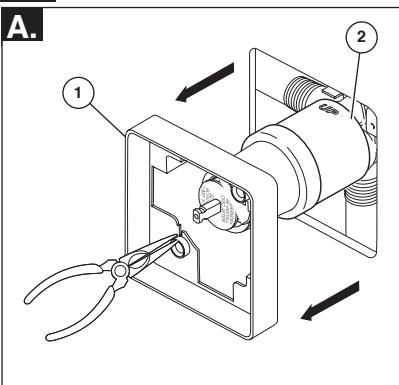
Retire el protector de yeso (1) de la tubería interna (2).
