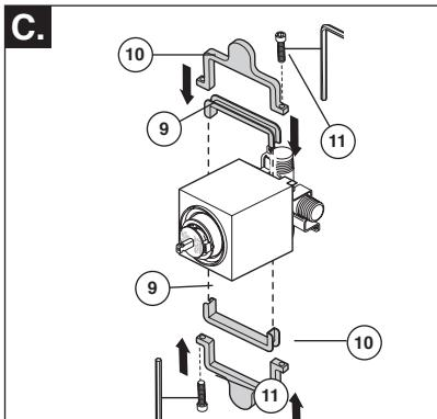
Arme los dos casquillos/manguitos de montaje (9) y las dos placas de montaje (10). Deslice los conjuntos de placa de montaje sobre el casquillo/manguito de manera que las lengüetas/placas (10) estén en la parte superior e inferior del casquillo del accesorio, tal como se muestra. Enrosque los tornillos (11) en las placas de montaje sólo lo suficiente para montar juntas las dos partes. Deslice las placas de montaje otra vez contra la pared y termine de apretar los tornillos (11).
