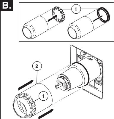
Si le modèle que vous installez nécessite une pièce d'espacement (1), introduisez-la dans le manchon (2) et poussez-la vers l'avant. Faites glisser le manchon sur la cartouche, le corps et le joint torique.
