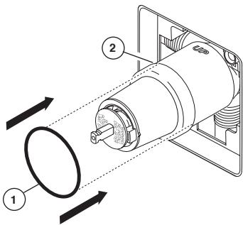
Faites glisser le joint torique (1) sur la cartouche et l'écrou à portée sphérique (2). Le joint sert de pièce d'espacement et il stabilise le manchon; il doit se trouver derrière l'écrou à portée sphérique.
