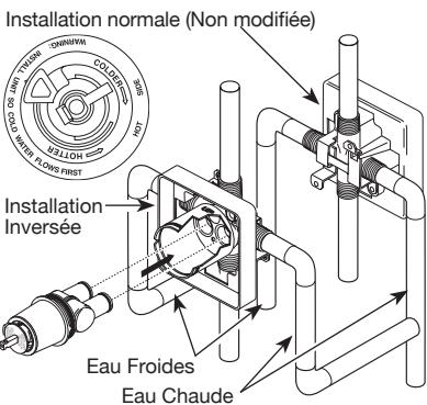
Dans le cas d'une installation dos à dos ou inversée (eau chaude à droite et eau froide à gauche), introduisez la cartouche de sorte que la mention « hot side » se trouve du côté droit. S'il ne s'agit pas d'une installation dos à dos ou inversée, sautez la présente étape et passez à l'étape 1C.
