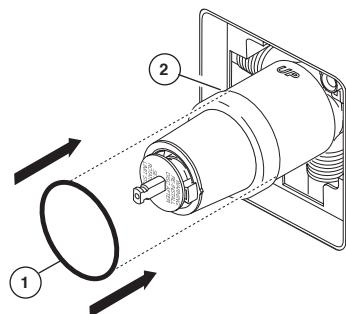
Deslice el aro O (1) sobre el cartucho y la tuerca tapa (2). El aro O, el cual funciona como un separador para estabilizar la manga, debe quedar apoyado en la tuerca tapa.
