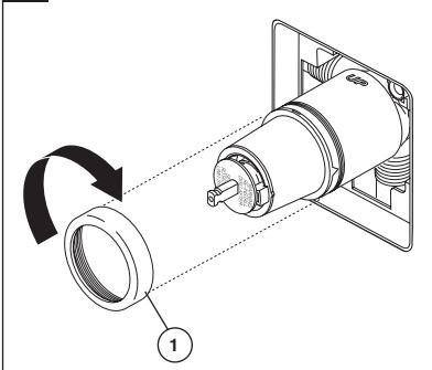
Deslice la tuerca tapa (1) sobre el cartucho y enrosque en el cuerpo de la válvula. Apriete a mano bien. .
