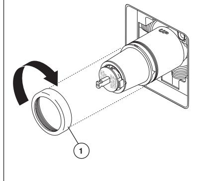
Faites glisser l'écrou à portée sphérique (1) sur la cartouche et vissez-le sur le corps. Serrez à la main fermement.
