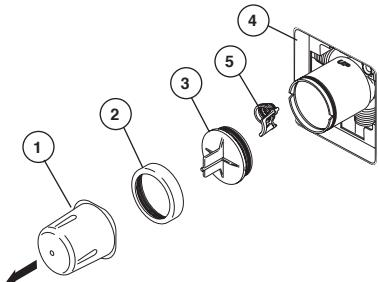
**Interrompez l'arrivée d'eau.** Enlevez le couvercle (1), l'écrou à portée sphérique (2) et le capuchon d'essai (3) du corps. Si vous n'installez pas l'appareil dans une paroi mince, vous pouvez retirer le protecteur (4) complètement. Si l'écran (5) est en place, enlevez avant d'installer la cartouche.
