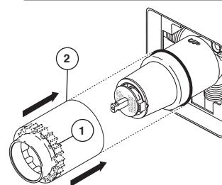
Si su modelo requiere un separador (1), insértelo en la manga (2) y empújelo hacia el frente. Deslice la manga sobre el cartucho, el cuerpo de la pieza y el aro O.
