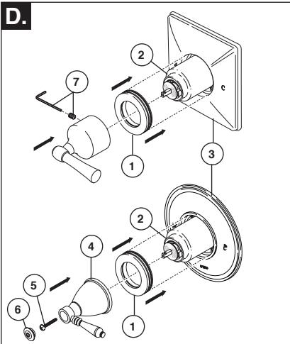
Glissez l'anneau de finition (1) sur le manchon de finition (2) et introduisez-les dans la plaque de finition (3). **Modèles T60P210 et T60P410 :** Fixez la manette (4) sur la tige à l'aide de la vis (5) et d'un tournevis à pointe cruciforme (Philips). Introduisez le bouton (6) dans la manette. **Autres modèles :** Fixez la manette sur la tige à l'aide de la vis de calage et d'une clé Allen (7).
