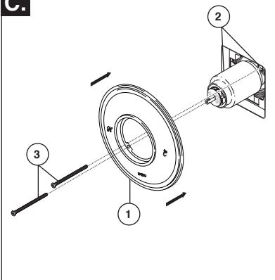
Fije la roseta con orificio (1) al soporte (2) usando los 2 tornillos suministrados (3). No apriete demasiado los tornillos de la roseta.
