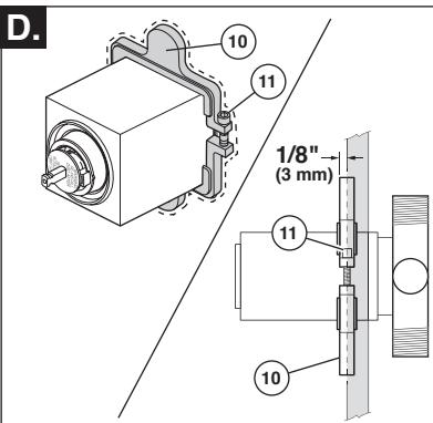
Usando las placas de montaje (10) como una guía, aumente el tamaño del agujero alrededor de la unidad de la tubería detrás de la pared, de manera que las placas pueden ser empujadas hasta 1/8" en la pared. Apriete los tornillos (11).
