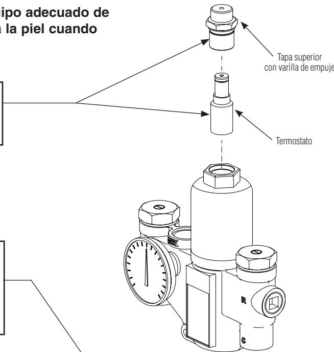
**B** Inserte una varilla de 8 mm de diámetro en la válvula hasta que toque la parte superior de la varilla de empuje que está adherida al pistón. Marque la longitud de la varilla dentro de la válvula. Empuje la varilla hasta que se detenga el pistón y marque la nueva longitud.
