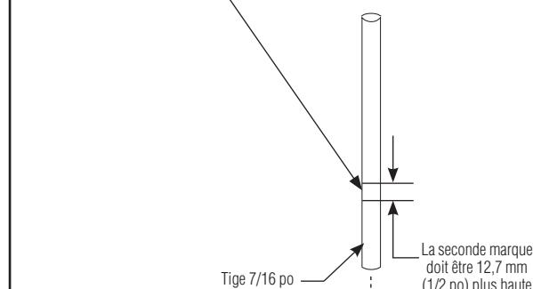
**C** Si la tige se déplace de moins de 12,7 mm (1/2 po), le piston ne se déplace pas librement en dedans du revêtement et doit être nettoyé :
