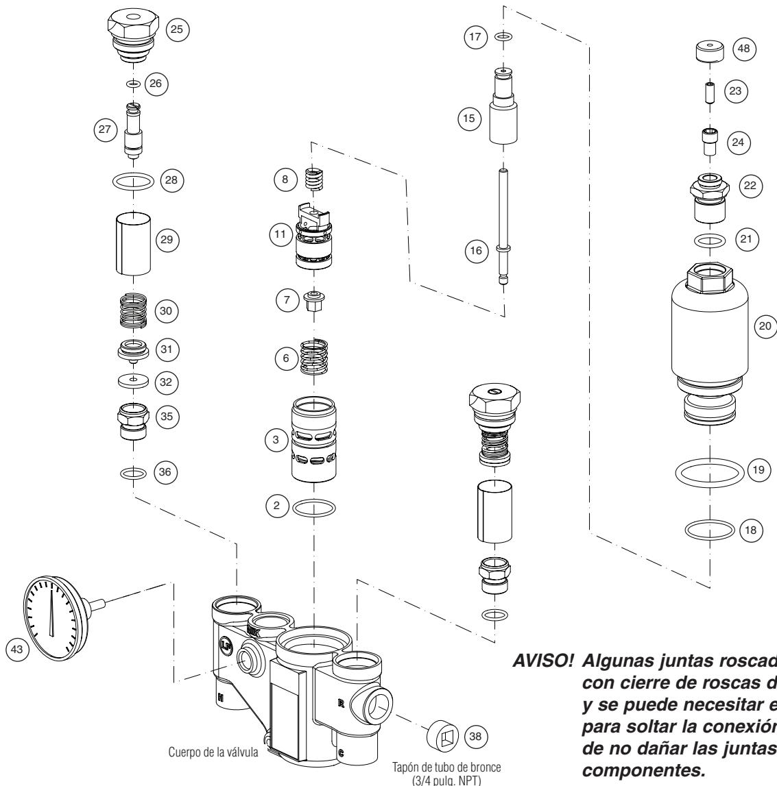
**AVISO!** Algunas juntas roscadas se montan con cierre de rosca de alta resistencia y se puede necesitar el uso de calor para soltar la conexión. Tenga cuidado de no dañar las juntas tóricas y otros componentes.
