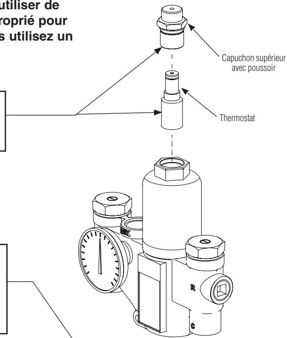
**B** Insérer une tige de 7/16" de diamètre dans la valve jusqu'à ce qu'elle touche le haut du poussoir attaché au piston. Marquer la longueur de la tige à l'intérieur du robinet. Pousser la tige jusqu'à ce que le piston arrête et marquer la nouvelle longueur.
