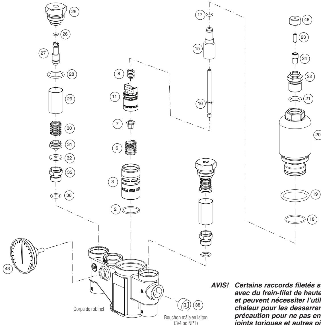
**AVIS!** Certains raccords filetés sont assemblés avec du frein-filet de haute résistance et peuvent nécessiter l'utilisation de chaleur pour les desserrer. Faire preuve de précaution pour ne pas endommager les joints toriques et autres pièces.
