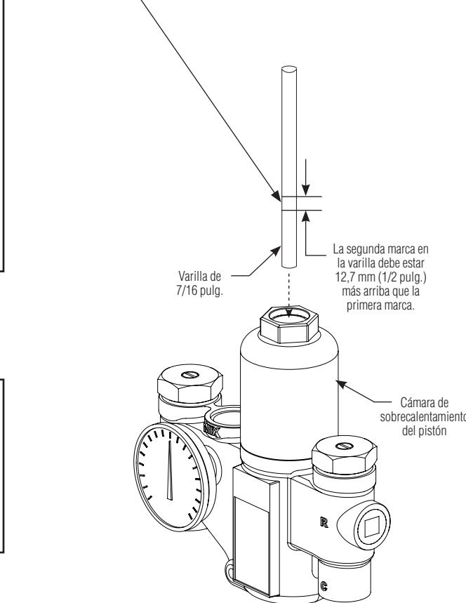
Si la varilla se desplaza menos de 12,7 mm (1/2 pulg.), el pistón no se mueve libremente dentro del revestimiento y se deben limpiar:
