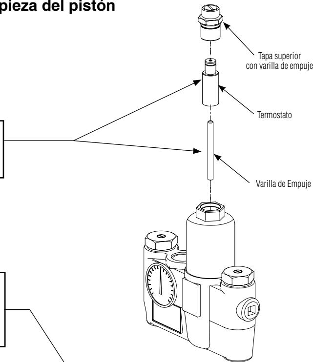
**B** Inserte una varilla de 8 mm de diá. en la válvula y en la cámara de sobrecalentamiento del pistón. Marque la longitud de la varilla dentro de la válvula. Empuje la varilla hasta que se detenga el pistón y marque la nueva longitud.
